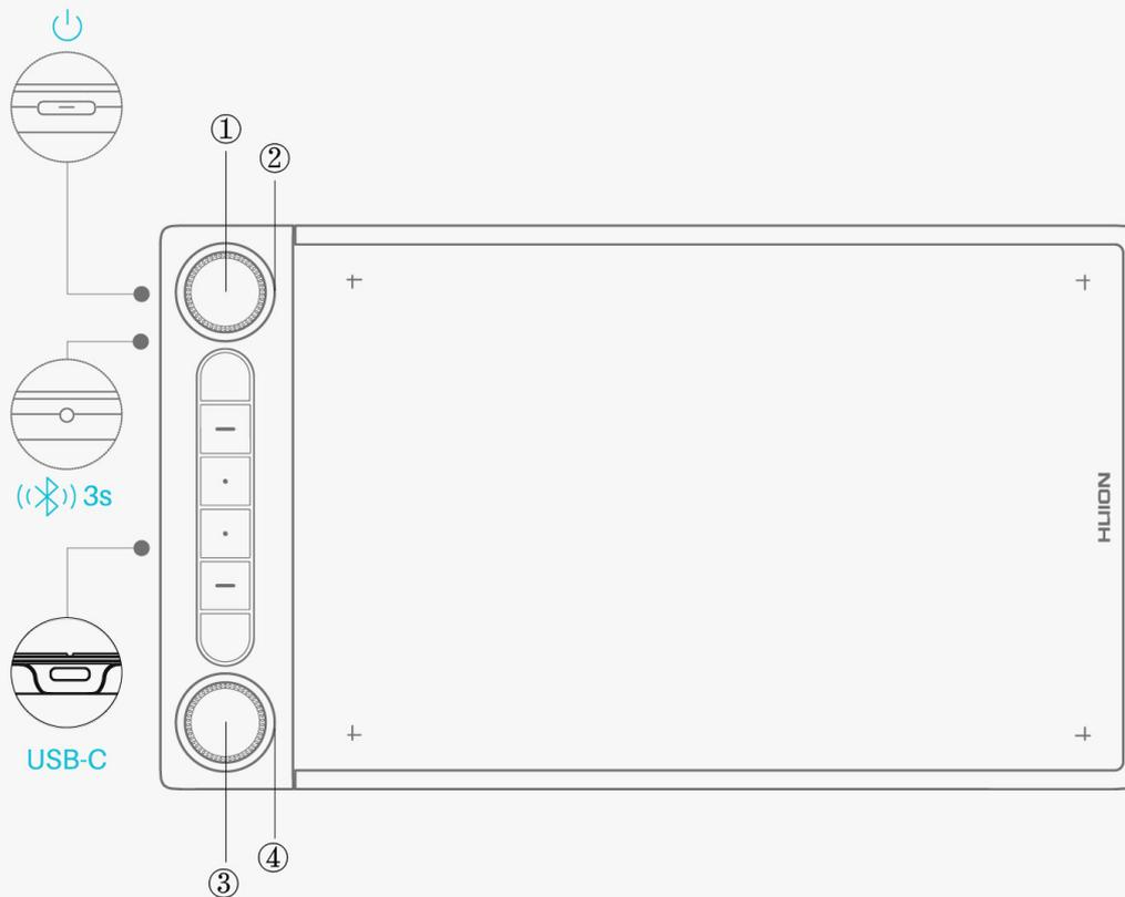
① Funktionsumschalter-Taste 1: Drücken Sie die Taste 1, um zwischen den Standardfunktionen von Drehknopf 1 oder den Standardwerkzeugen Ihres Windows-Radial-Menüs zu wechseln. [Siehe Abschnitt](#)
