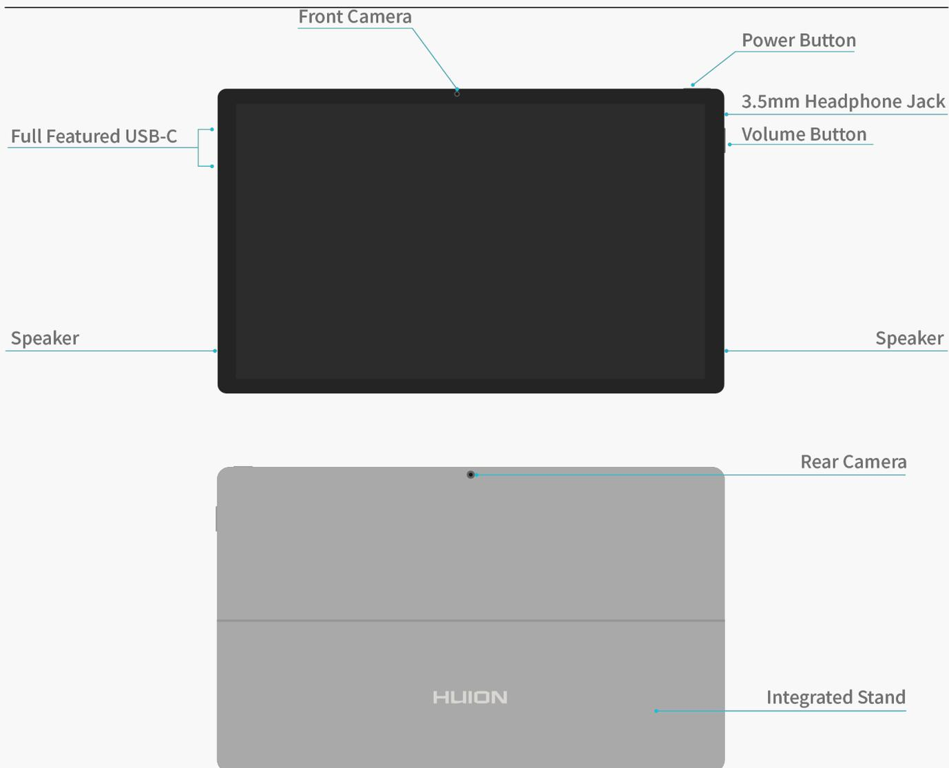
**Avviso:** Supportando la regolazione dell'angolo, il cavalletto può sostenere il dispositivo entro un angolo di 30-75°. Il supporto utilizza cerniere di scorrimento e fornisce una capacità portante limitata, quindi è applicabile solo in alcuni scenari quali, per esempio, guardare un video, giocare o navigare sul web. Per disegnare, utilizzare il supporto da disegno in dotazione.
